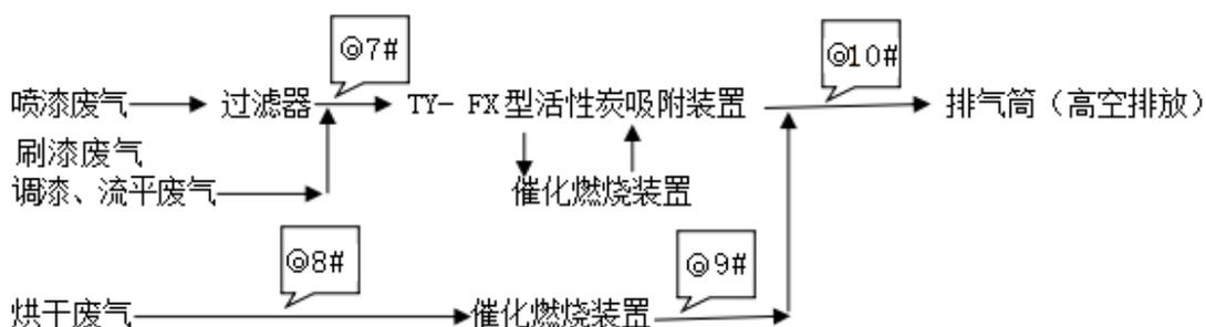
4、Q1~Q6 喷漆线(喷漆、调漆、流平)废气
